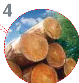
Sibirisches Lärchenholz wird außenseitig für Rahmen und Flügeln verwendet. Sibirische Lärche hat eine ähnliche Haltbarkeit wie Eichenholz und hat keine Äste.
