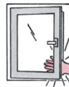
Vorsicht! Ein zuschlagender Flügel kann zu Verletzungen führen. Beim Zudrücken nicht zwischen Flügel und Blendrahmen greifen.
