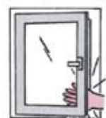
Vorsicht! Ein zuschlagender Flügel kann zu Verletzungen führen. Beim Zudrücken nicht zwischen Flügel und Blendrahmen greifen.
