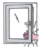
Vorsicht! Ein zuschlagender Flügel kann zu Verletzungen führen. Beim Zudrücken nicht zwischen Flügel und Blendrahmen greifen.
